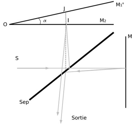
Les deux miroirs ne sont pas perpendiculaires : les interférences sont localisées à la surface de  $M_2$  (réglage en coin d'air)
