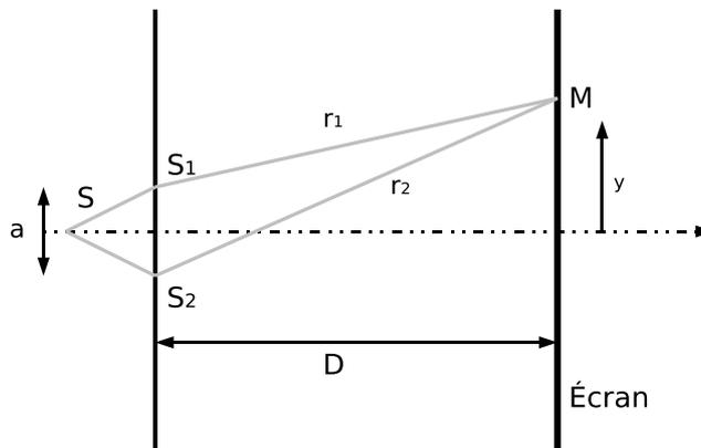
$I(M) = I_0 \left[ 1 + \cos \left( \frac{2\pi}{\lambda} (r_2 - r_1) \right) \right]$  Les surfaces d'égalité intensité sont des hyperboloïdes de révolution autour de  $(S_1S_2)$  et de foyers  $S_1$  et  $S_2$ .
